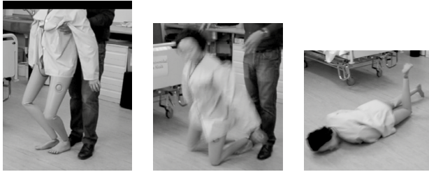
Figura 1: Secuencia del desarrollo de una caída: situación de partida, con el maniquí sujetado manteniendo las piernas ligeramente flexionadas, primer impacto con las piernas y finalmente el impacto del tronco.
